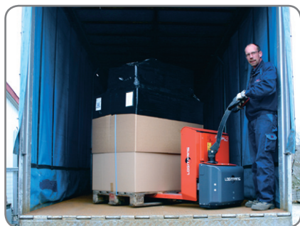
Panther Maxi (kapasitet 1800 kg) anbefales til tung palletransport, f.eks. til transport og spedisjon.
